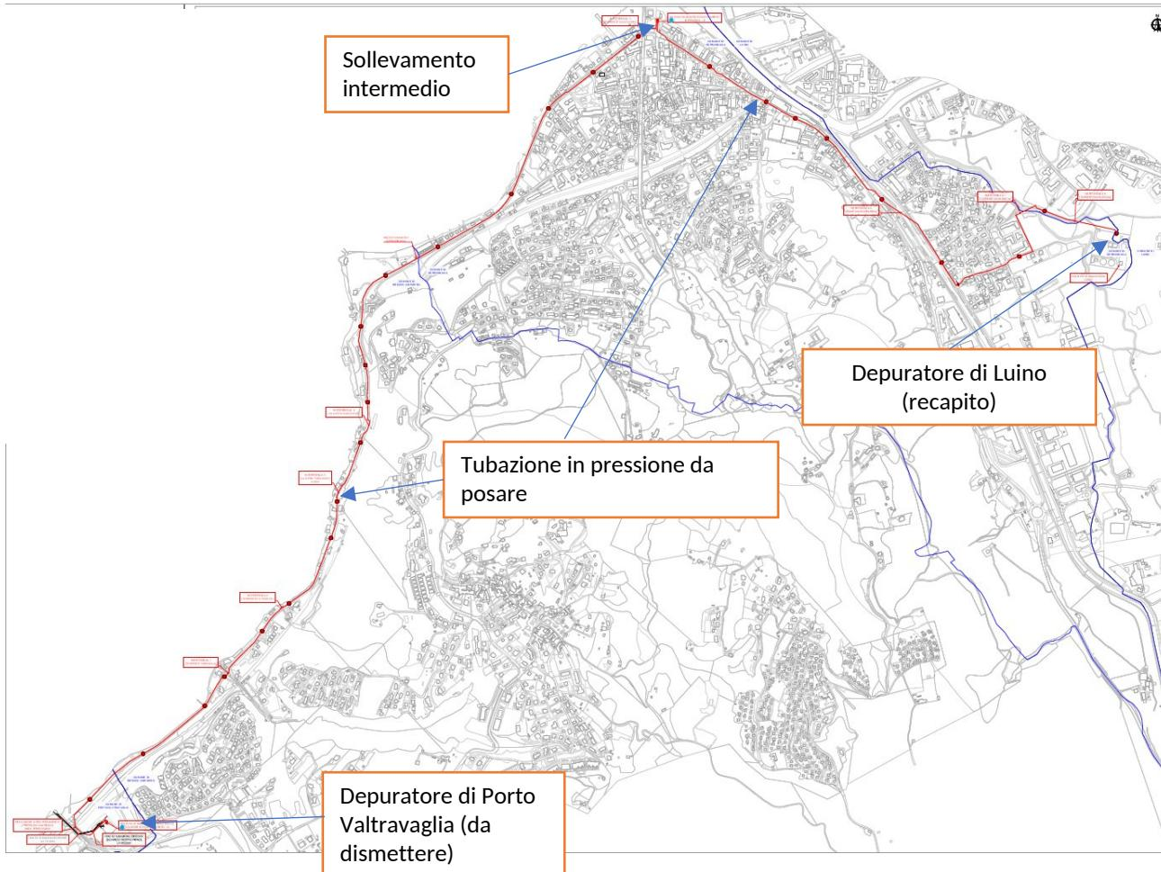
**DE02DISTRIGO: Dismissione dell'impianto di depurazione di Porto Valtravaglia; collettamento al depuratore di Luino. Installazione sollevamento presso attuale depuratore di Portovaltravaglia, sollevamento intermedio nel Comune di Germignaga, ~6 km rete in pressione DN400. **Commessa finalizzata al superamento di Procedura di Infrazione Comunitaria.****
